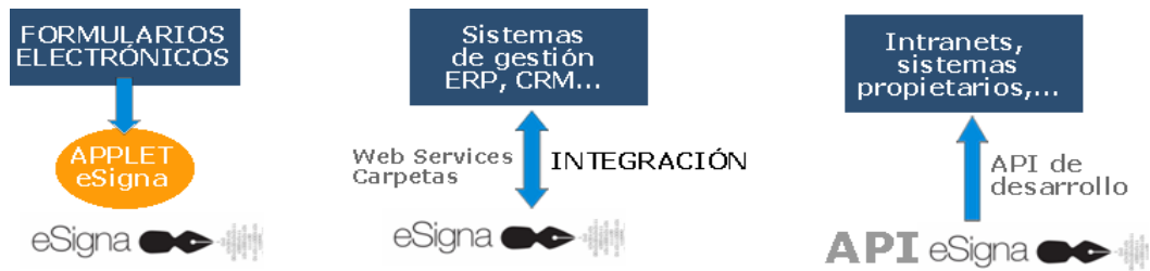
Ilustración 3: a) Introducción de la firma electrónica en los formularios existentes en la empresa mediante applets de firma ya desarrollados. B) Llamadas desde las aplicaciones propias a servicios eSigna instalados en el servidor, mediante la tecnología de Webservices. C) Desarrollo de soluciones personalizadas utilizando las APIs de firma electrónica y workflows.
